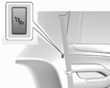
Кнопка электропривода складывания со стороны водителя
